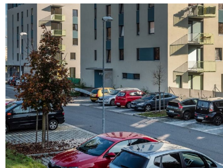
017 Parkoviště s využitím zatravňovací betonové dlažby. Při návrhu každé 3 až 4 parkovací stání oddělit stromem, aby bylo zajištěno stínění a případný vsak dešťové vody. [ Chrudim ]
