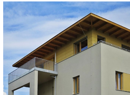
100 Ustupující podlaží tvořené deskovým materiálem s přesahem střechy pro zajištění stínění. [ Zbýšov ]
